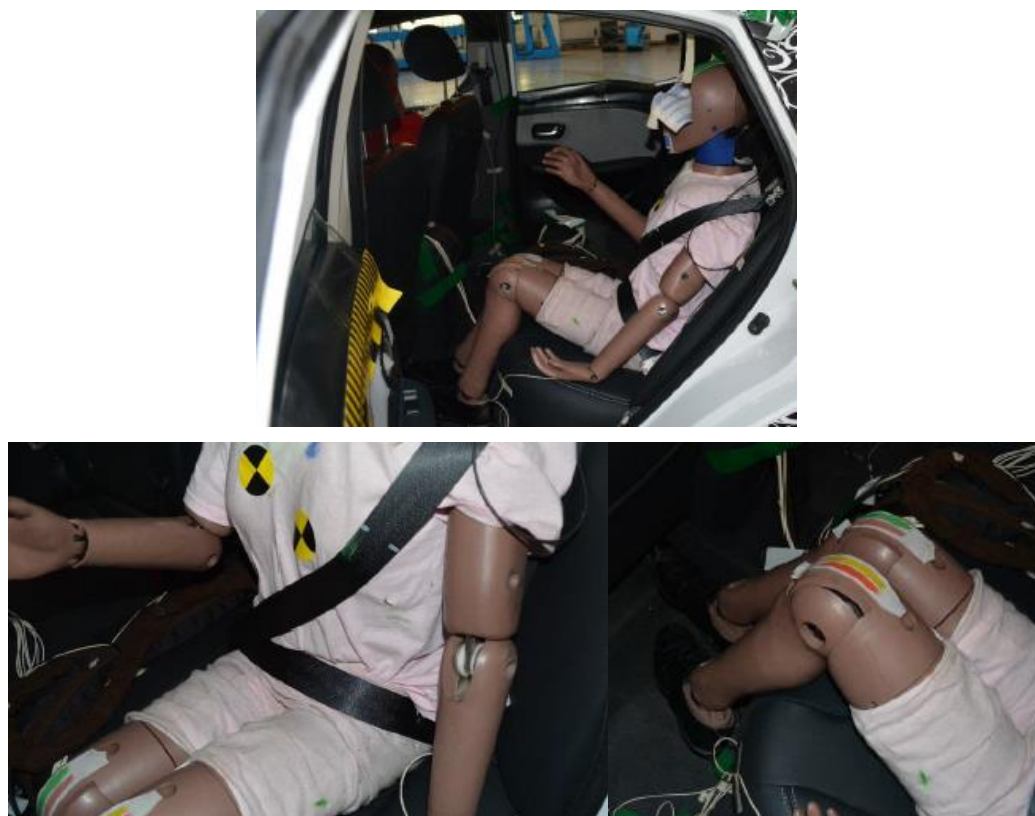
图 4.35 640DB 实车试验后后排约束系统表现
