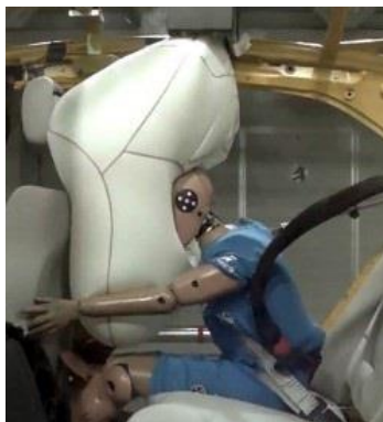
图 1.2 新型车顶安装式后排安全气囊技术
