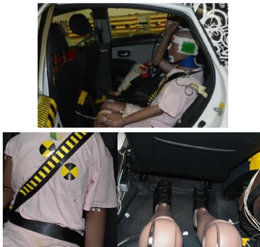
图 4.30 50FF 实车试验后后排约束系统表现
