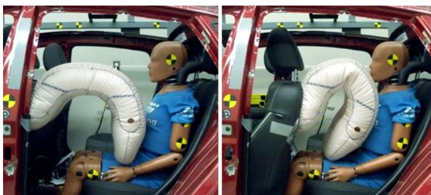
图 1.3 新型前排安装式后排安全气囊技术
