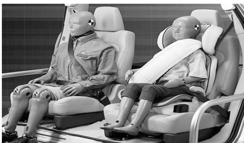
图 1.1 气囊式安全带技术
