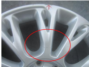
图 1 13 度冲击试验裂纹失效
