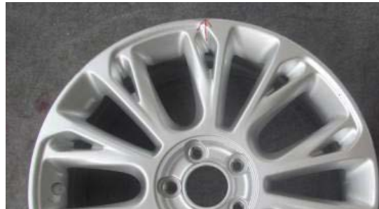
图 5 修改后方案 13 度冲击（相对气门嘴 90 度）试验结果
