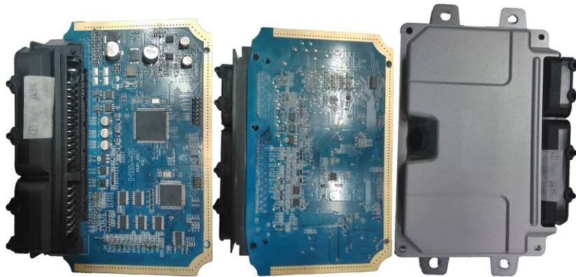
图 3.18 整车控制器实物照片
